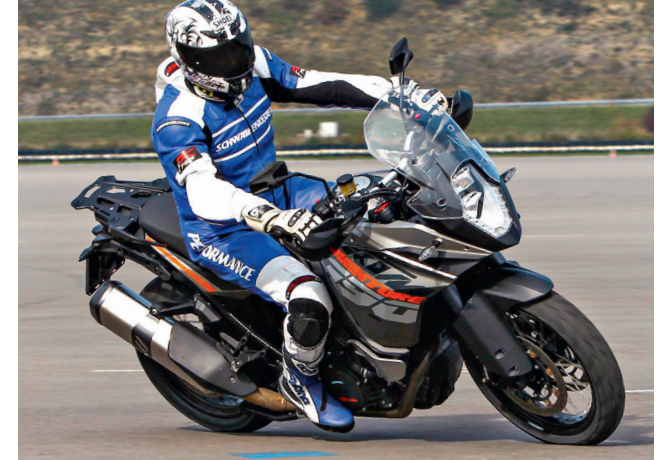
Kurven-ABS hilft, beim Bremsen in Schräglage die Spur zu halten und nur gerade so stark zu bremsen, dass das Vorderrad nicht wegrutscht
