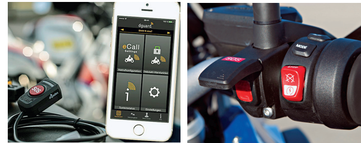
E-Call, das automatische Notrufsystem, ab 2018 Pflicht für neue Autos, gibt es für Motorräder von digades (links) und ab Werk von BMW (rechts)
